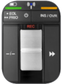
Schiebeschalter: Aufnahme, Stop, Wiedergabe, Rücklauf (LFH3010)
